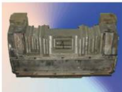
Componenta din matrita pentru "inductori de cale ferata"
